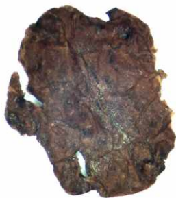
Подготовленный образец нашивка-«пайетка» старого покрывала для исследования (Микроскоп МБС-10, цифровая камера DCM 200, увеличение в 20 раз).
