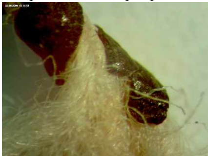
Подготовленный образец золотой нити старого покрыва для исследования (Микроскоп МБС-10, цифровая камера DCM 200, увеличение в 80 раз).
